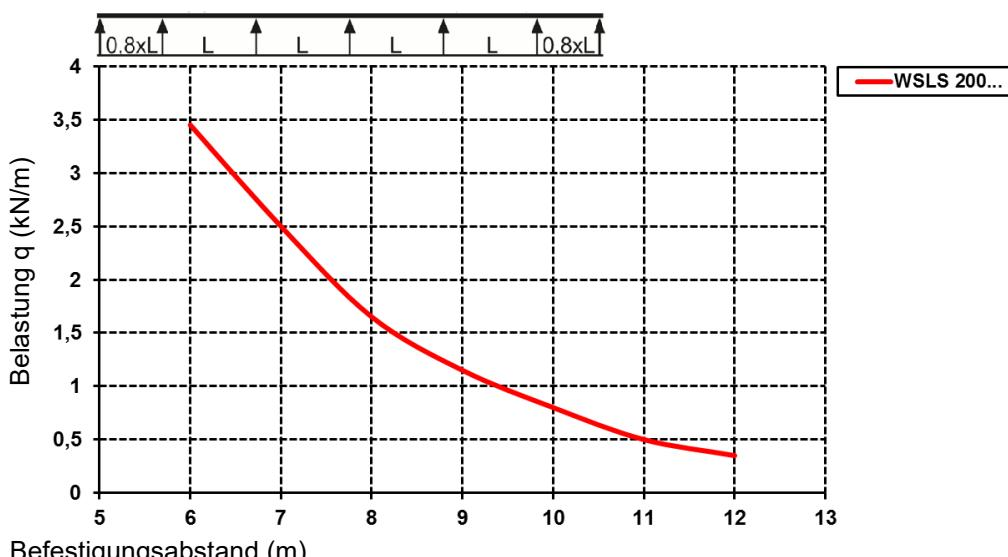
Die im Diagramm aufgeführten Belastungsangaben sind unabhängig von der Lage der Verbinder.
