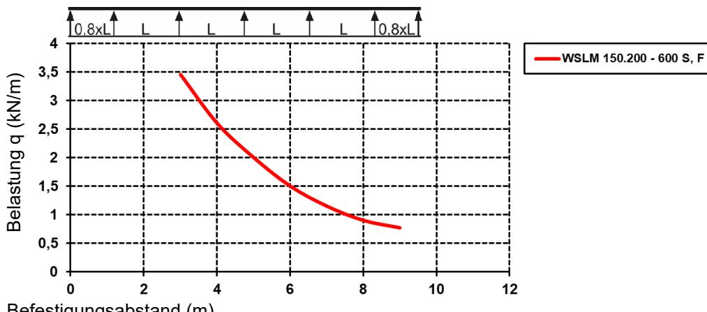
Die im Diagramm aufgeführten Belastungsangaben sind unabhängig von der Lage der Verbinder.
